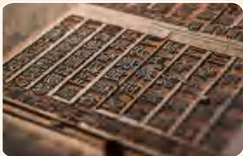
**金陵刻经印刷技艺**，木刻水墨雕版印刷技艺是中国古老雕版印刷的遗存，在世界印刷史上占重要地位。主要分为刻板、印刷与装订三个部分，每个部分又有若干道工序组成。金陵刻经印刷技艺版式疏朗、字大悦目、刻印考究、纸墨精良，被称为金陵本。
